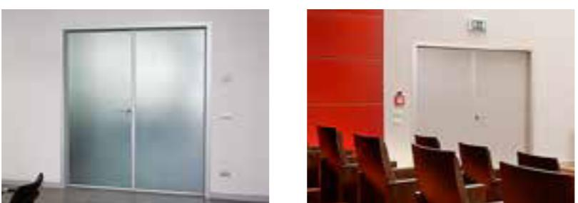
Porta a battente su muratura ad anta singola o doppia, in vetro temperato sp.10 mm trasparente, satinato o serigrafato. Ante in vetro senza telaio o con cornice perimetrale, oppure ante cieche in tamburato sp. 40 mm con finitura laminato, laccato o placcato legno. Lo stipite è realizzato in alluminio estruso colore ox naturale coordinato con i profili delle pareti divisorie. Porte scorrevoli a richiesta.
